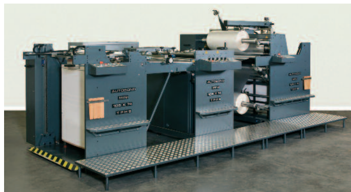
Autobond Thermolaminiermaschine für die Druckveredelung bis zum Format 106 cm x 145 cm, einseitig oder zweiseitig, bis zu 170 m/Min.
